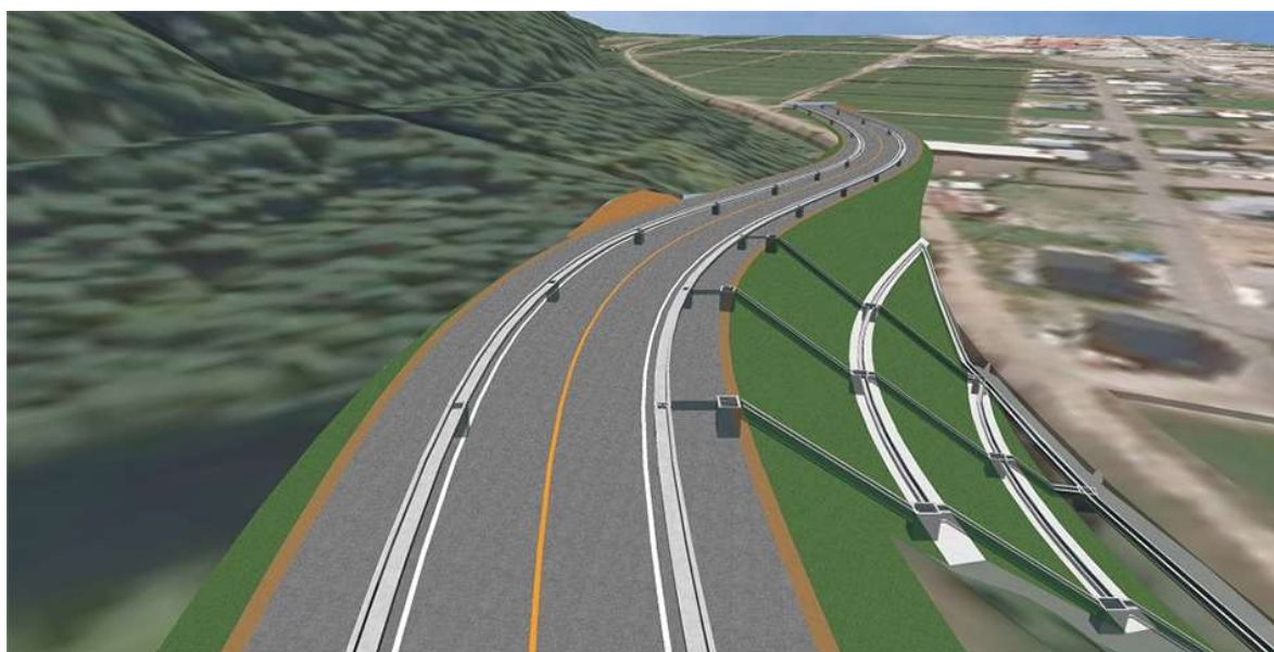
ROAD_Kitで作成した道路モデルに排水モデルを配置
