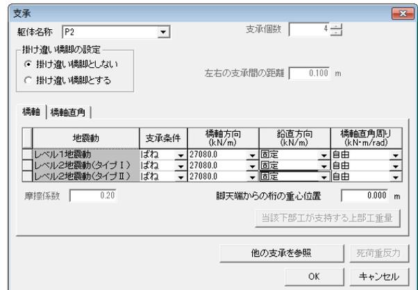
■ 指定形式入力では、橋軸直角方向の場合、橋脚間の固有周期特性により、橋脚の固有周期の最大最小の比が1.5以上になった場合、桁と脚を一体系として再度固有周期を計算します。
