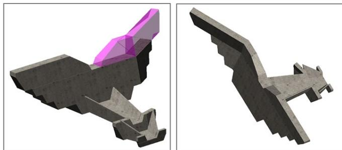
3D地形図に砂防堰堤を配置可能です。構造物はソリッドなのでコンクリート体積が求められます。
